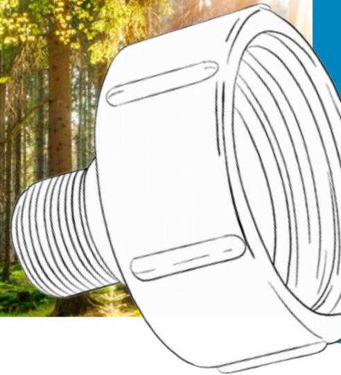
Das gängigste Gewinde im Bereich der IBC ist das sogenannte S60x6 Gewinde. Dabei handelt es sich um ein 2-zölliges Grobgewinde, welches bei fast allen Herstellern als Standard verbaut wird. Dies entspricht einer Nennweite von DN50 (auch häufig „NW50“).
