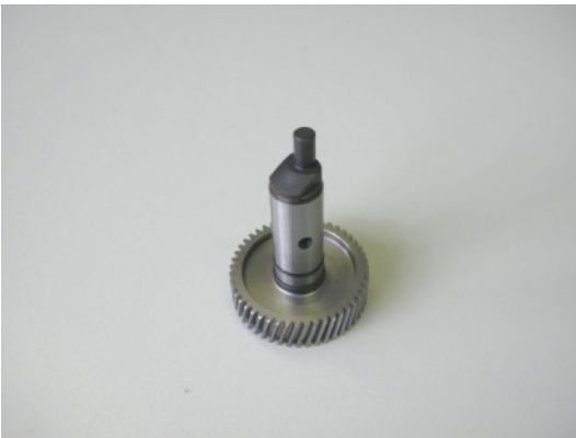
GT369814 Reparatursatz Stirnrad bestehend aus: GT369312 Stirnrad mit Welle GT369213 Exzenterzapfen GT369214 Lagerbuchse TA004029 O-Ring TA008542 Filzring
